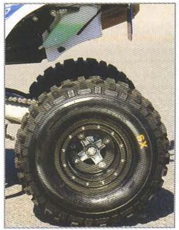
Leichtbau: Räder aus Karbon von Goldspeed verleihen dem Quad eine moderne Optik
